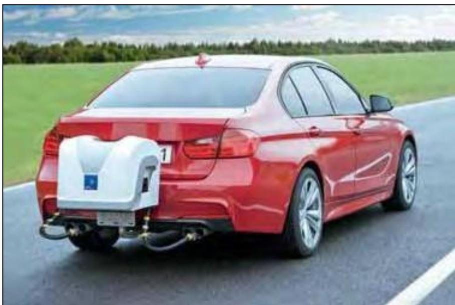
Рисунок 2: Портативная система измерения выбросов (PEMS). Фото – источник: AVL M.O.V.E. [7]
